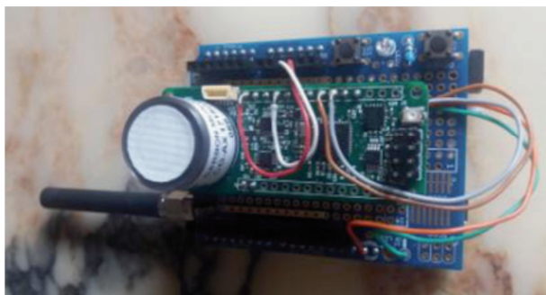
12 Il sistema di misura complessivo. Si nota la struttura a sandwich, dove alla scheda per il collegamento con la rete SigFox (per la quale si vede spuntare l'apposita antenna) è applicato, tramite apposito shield, il circuito di condizionamento dei segnali provenienti dal sensore di monossido di carbonio.
